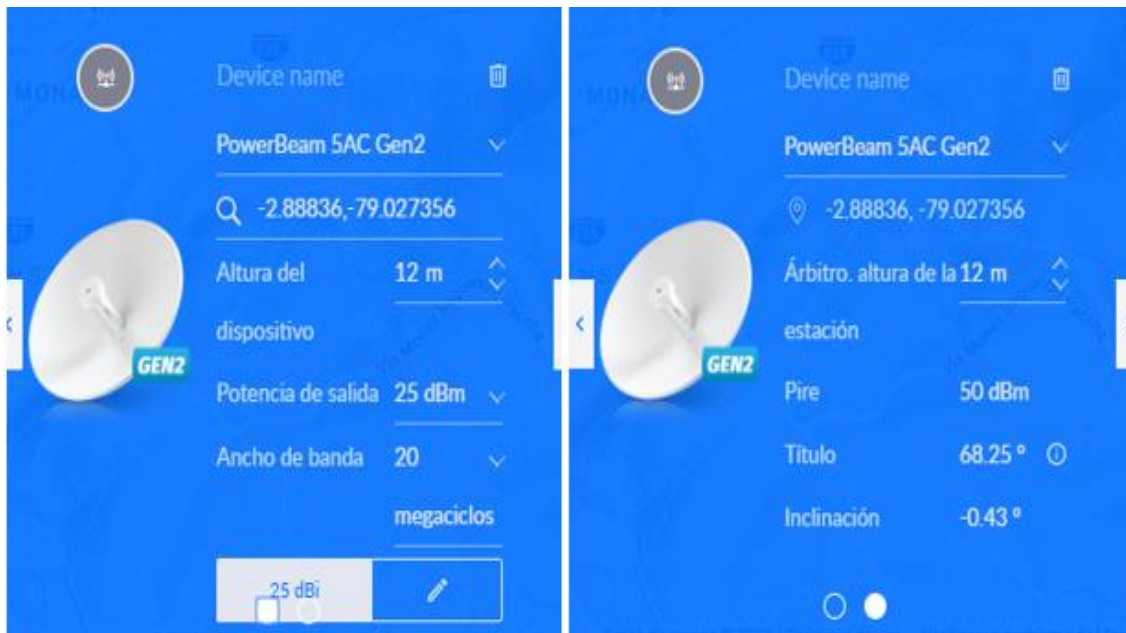
Figura 34 Análisis PowerBeam 5AC Gen2 Ricaurte - Tejar
