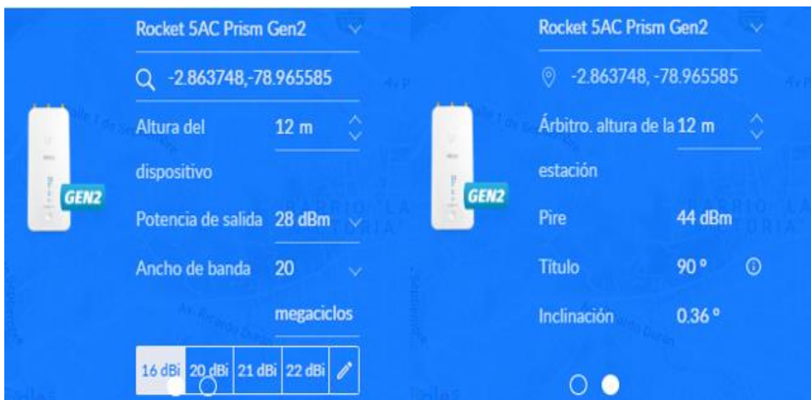
Figura 33 Análisis Rocket 5AC Prism Gen2 Ricaurte - Tejar
