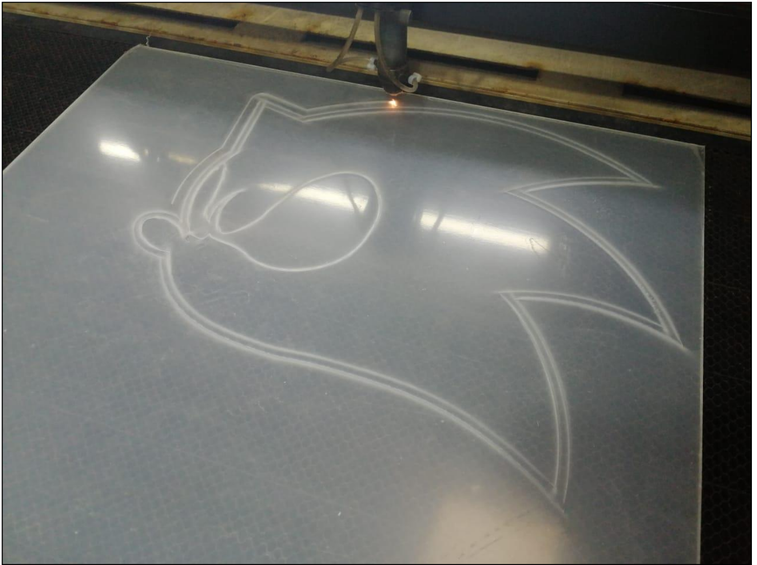
Ilustración 38 Corte laser de acrílico transparente para el fondo de la figura y el pegado del neón Flex.
