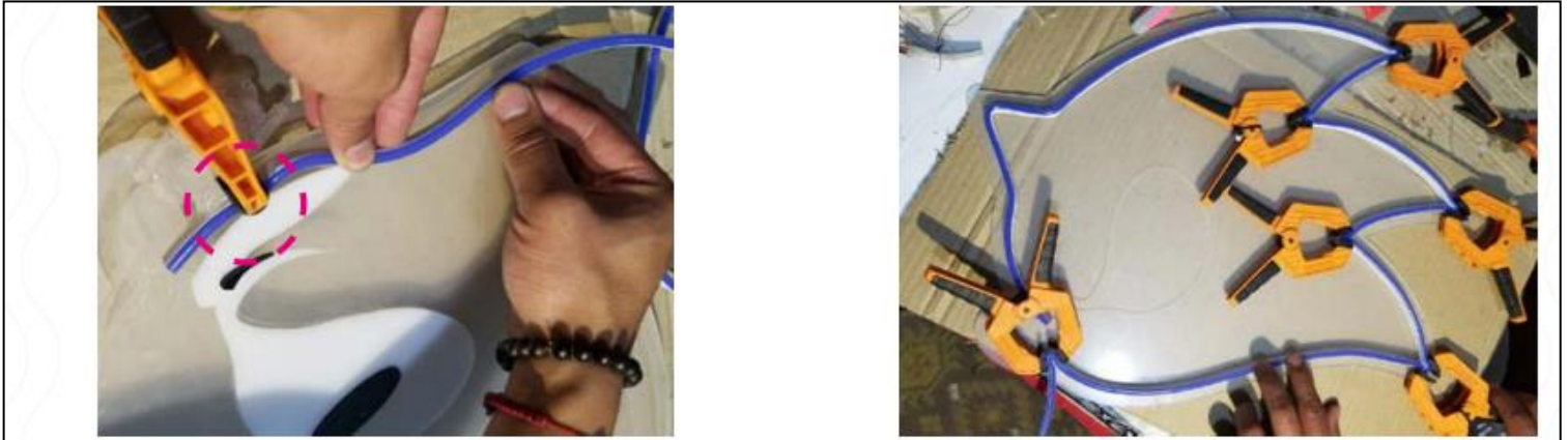
Ilustración 40 pegado del neón Flex más el acople de partes flotantes en volumen.
