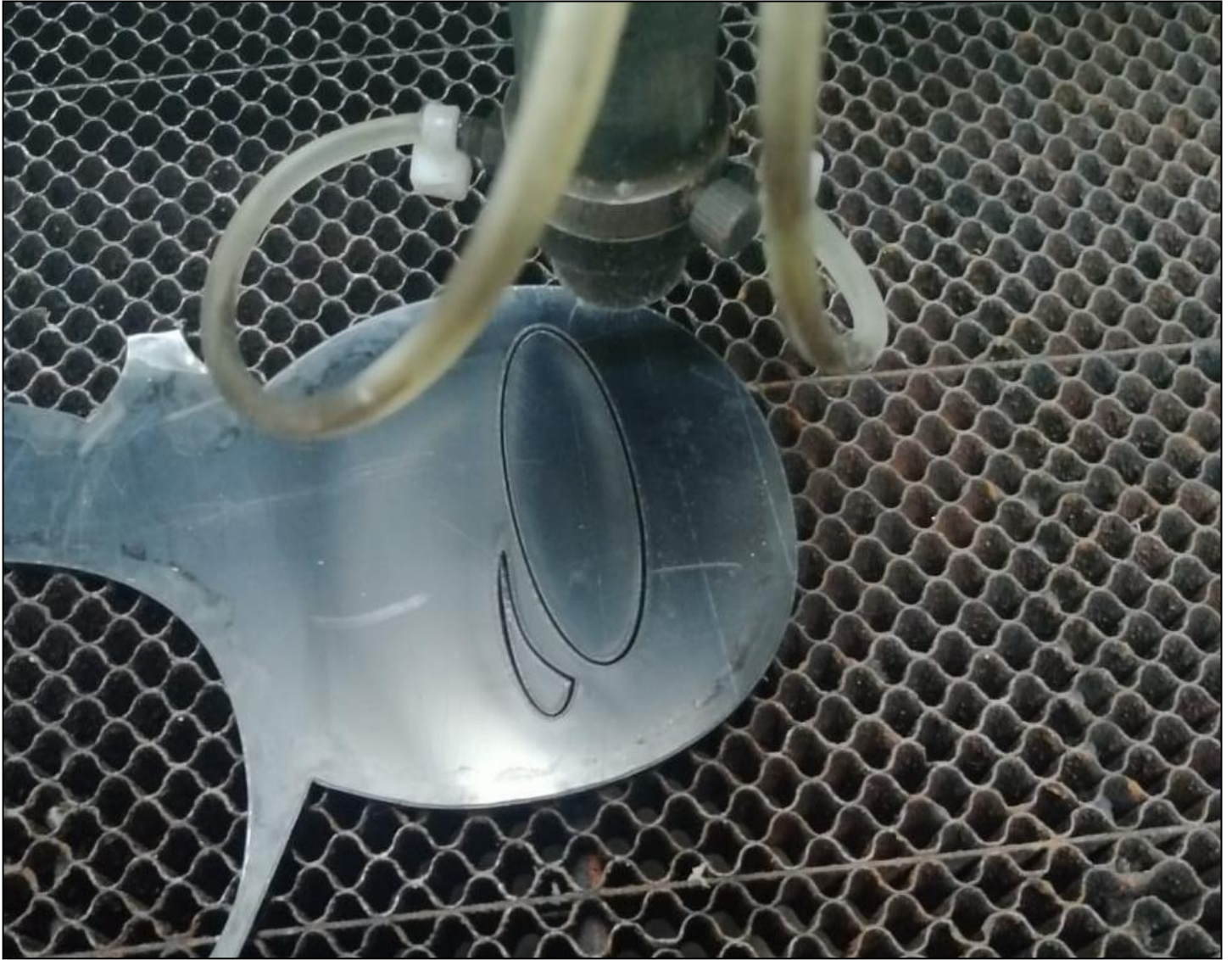
Ilustración 37 Corte laser de acrílico negro para los iris de los ojos.
