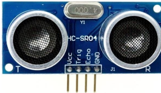
Figura 8 Permite medir la distancia mediante ultrasonido desde 2cm hasta 450cm, ideal para usar con arduino o PIC, muy utilizada en la robótica.
