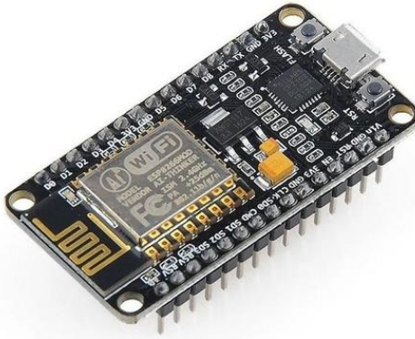
Figura 7 Chip de bajo costo wifi, con un stack TCP/IP completo y un microcontrolador.
