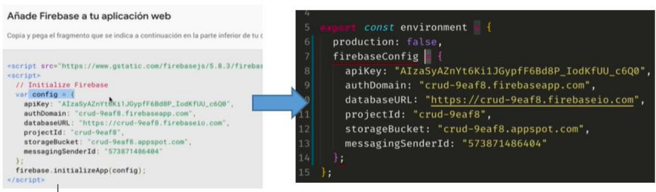
Ilustración 6 configuración de firebase para nuestra app
