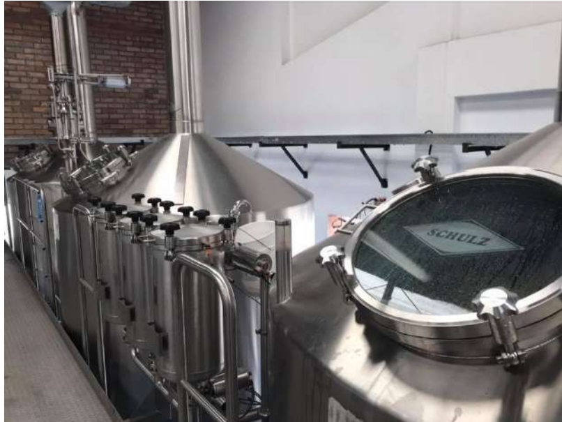
Tanques de cocción de cebada y trigo para la elaboración de cerveza
