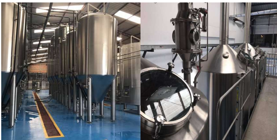
Ilustración 1 Tanque de reposo cerveceria la Paz Ilustración 2 Tanque de cocción de la cerveza
