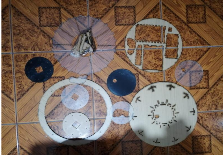
Figura 17: Piezas cortadas en MDF y Acrílico
