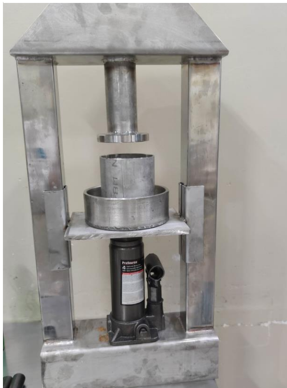
Ilustración 13. Prensa hidráulica para extracción de aceite en frío
